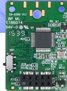
Transcends USB Flash Module dienen als Speichererweiterung für industrielle Computer. Diese kompakten Speicher benötigen nur minimale Stromversorgung und unterstützen mechanische Schreibschutz-Schalter. Auf Grund des kleinen Formfaktors sind die USB Module besonders gut geeignet für den Einsatz in kompakten embedded Systemen, in denen nur wenig Platz zur Verfügung steht.
